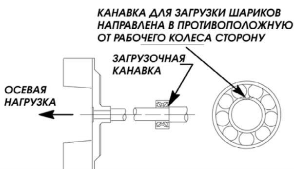
**УСТАНОВКА ПОДШИПНИКА ПРОИЗВОДСТВА NEW DEPARTURE ИЛИ VCA/FEDERAL MOGAL СЕРИИ 5300 W**
