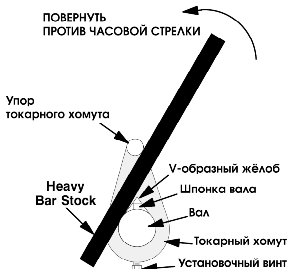
Рис. Е-3. Освобождение рабочего колеса
