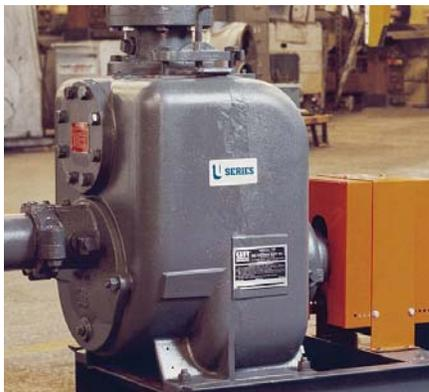
Насос U Series® перекачивает агрессивные сточные воды на мясокомбинате в штате Колорадо, США.
