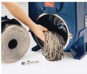
**Съемная крышка и пластина износа**
